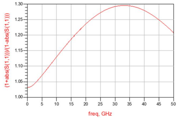
加 300um 双键合线的测试结果
