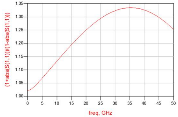
加 300um 双键合线的测试结果
