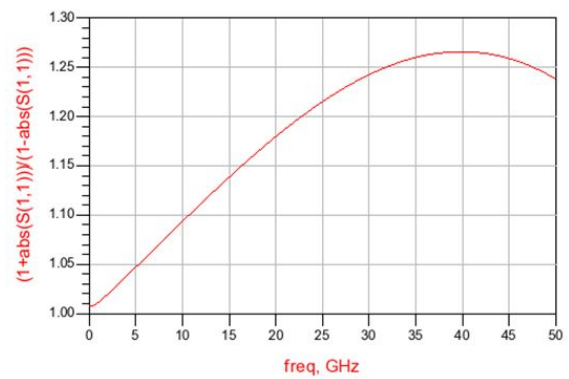
加 300um 双键合线的测试结果
